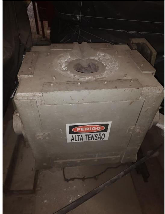
**Figura 3. Cadinho de capacidade de 25 kg, a ser reparado**
