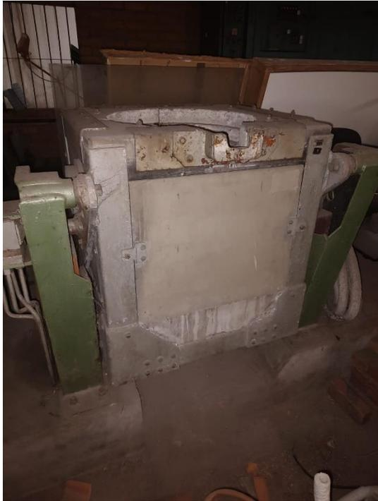
**Figura 2. Cadinho de capacidade de 100 kg, a ser reparado**
